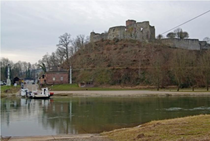
Abb. 8: Die Fähre in Polle (Lkr. Holzminden) ist an zwei Tragseilen oberhalb der Weser befestigt, so dass die Fährverbindung kein Hindernis für durchfahrende Schiffe darstellt.
