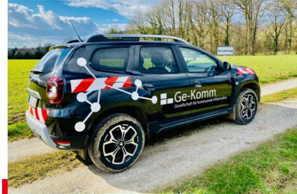
Abb. 14: Mit Hilfe eines geländegängigen Fahrzeuges wurden alle Wirtschaftswege erfasst, bewertet und in einem regelmäßigen Abstand von 50 m fotografiert. Foto: Ge-Komm GmbH
