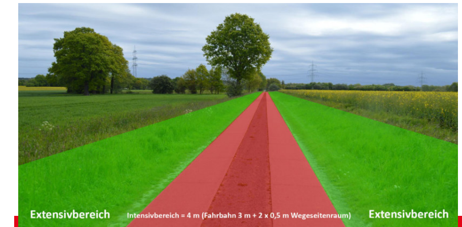
Abb. 17: Grundsätzlich sollten alle Wege einen extensiven und einen intensiven Pflegebereich unterteilt werden. Im extensiven Bereich kann ökologisch gemäht gepflegt werden, während der „Intensivbereich“ aus Gründen der Verkehrssicherungspflicht regelmäßig gekürzt wird. Foto: Ge-Komm GmbH
