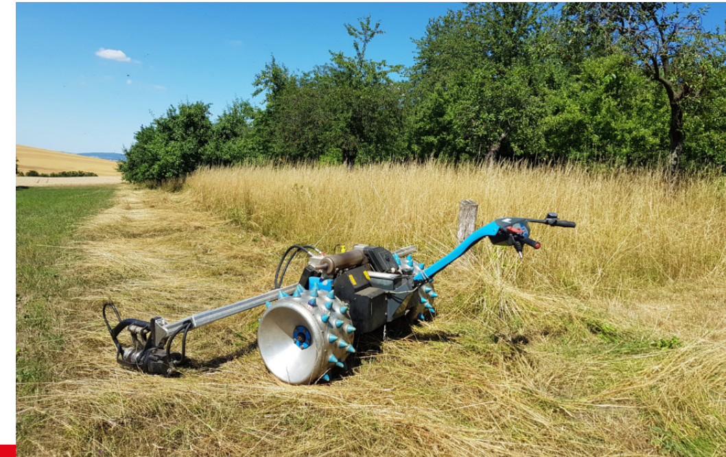
Abb. 18: Generell kann bei der Mahd in schneidende und rotierende Technik unterschieden werden. Bei Rotationsmähern kann eine Mähgutzerkleinerung – bekannt als Mulcher- hinzukommen. Bei allen Techniken, die mit hohen Geschwindigkeiten arbeiten, dadurch eine Sogwirkung aufweisen und zusätzlich eine Zerkleinerung des Mahdgutes bewirken, ist die schädigende Wirkung auf Tiere im Grünland am größten. Untersuchungen haben gezeigt, dass durch das Mulchen ca. 88 % der Insekten getötet oder verletzt werden (van de Poel & Zehm 2014: 39). Geräte, wie der hier abgebildete Hand-Motobalkenmäher, haben sich als für die Fauna schonendste Mähvariante herausgestellt. Foto: www.ökologischmahen.de
